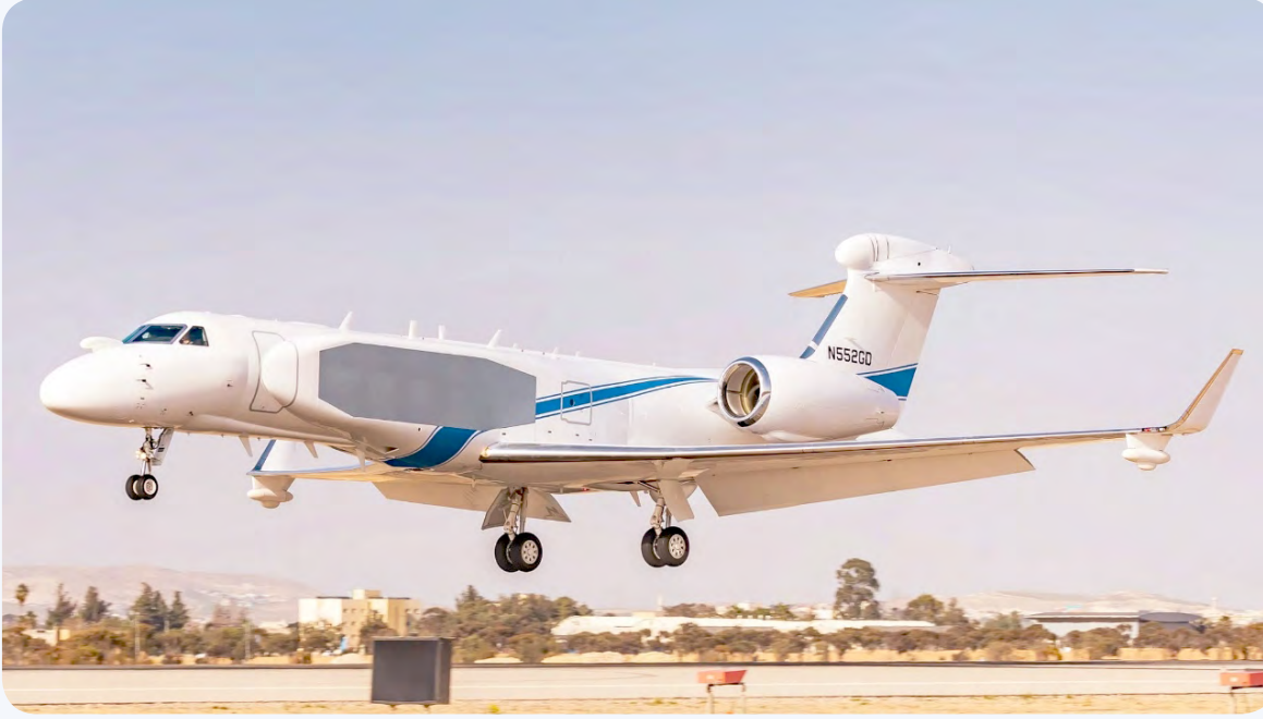
طائرة Nachshon Oron والتي تمتاز بوجود الرادارت وأجهزة الاستشعار الخاصة بها في أجناب وباطن ومقدمة ومؤخرة الطائرة
